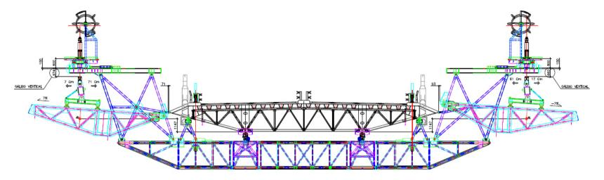
SECCIÓN TRANSVERSAL - ANÁLISIS GÁLIBOS EN MANIOBRA IZADO DOVELA CON PTE. TRANSVERSAL +7% Y -7% ESCALA 1:150
