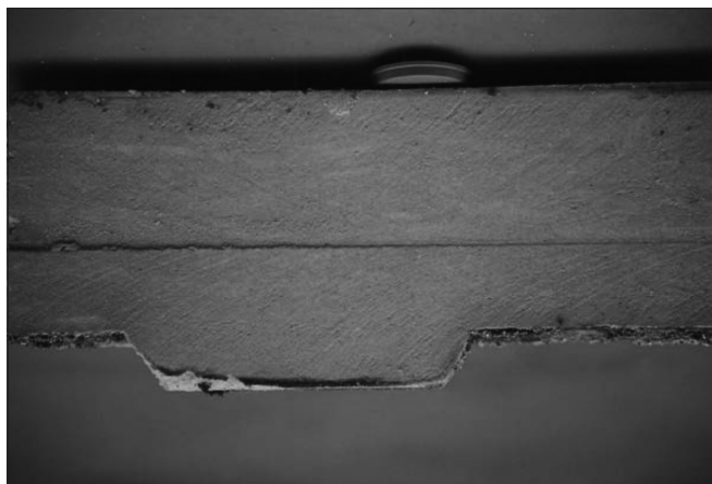
7. ábra: Karbamid-formaldehid gyantával kötött hőszigetelő és páraszellőző perlit tetőelem
