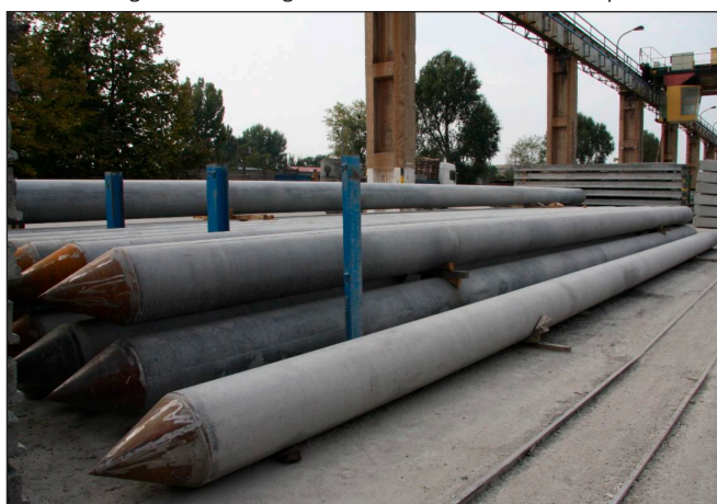
7. ábra: Pörgetett technológiával készült 18,0 m hosszúcölöp
