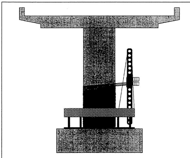
Fig. 2 Automatic wrapping (fib, 2000)
