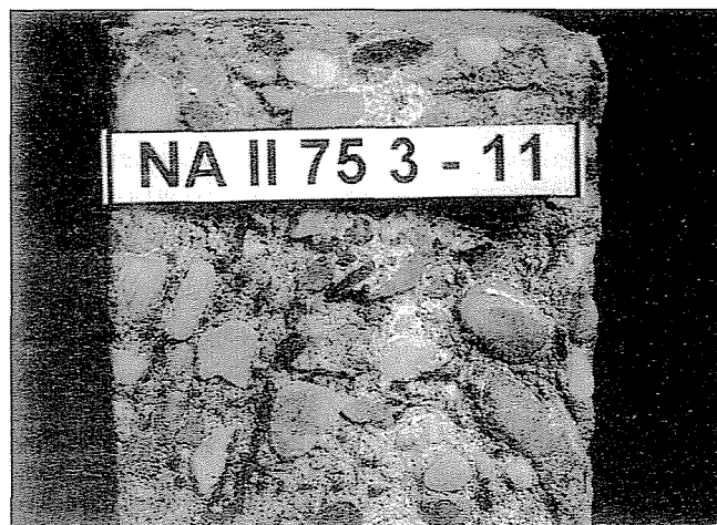
3. fénykép: I. fagyasztási kísérlet forgatással, „N” beton, 75 \text{kg/m}^3 acélszállal (a felszínen álló/fekvő huzalok rozsdásak)
