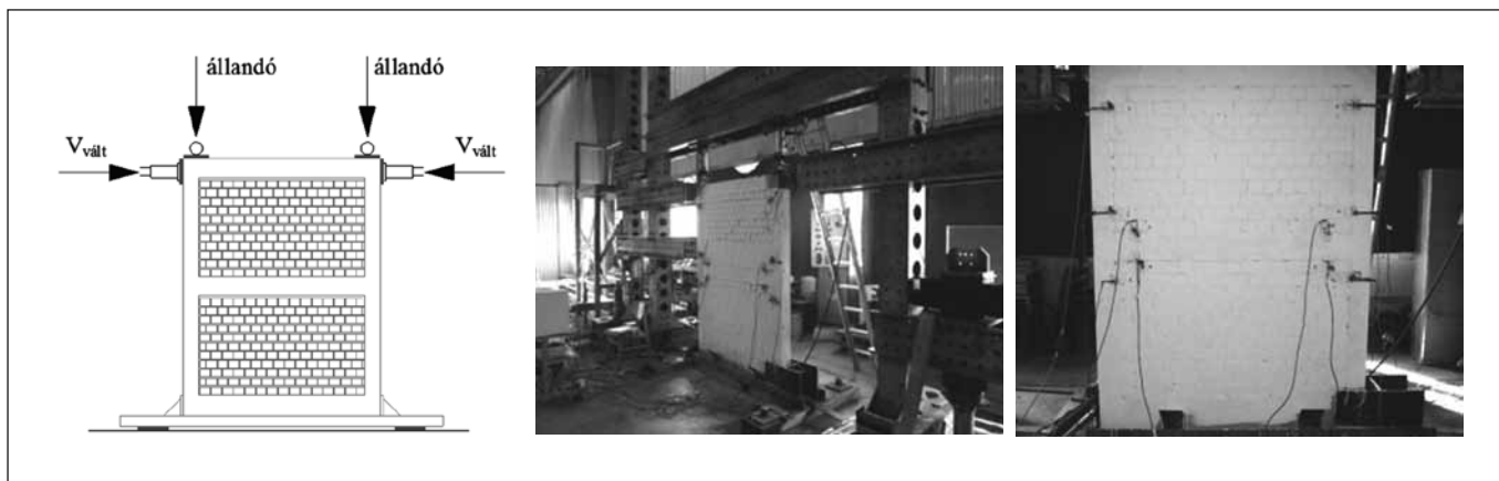
5. ábra: Függőleges és vízszintes hidraulikus sajtók elrendezése
