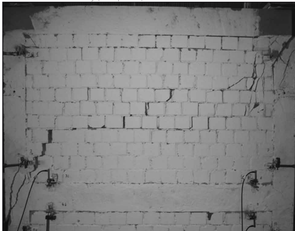
8. ábra: Jellemző tönkremenetel fotója (Kc1-2. próbatest)
