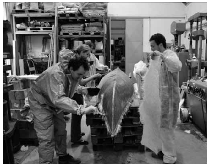
2. ábra: A hajótest zsaluzatának kialakítás üvegszálas műanyagból egy tényleges versenyhajó felhasználásával
