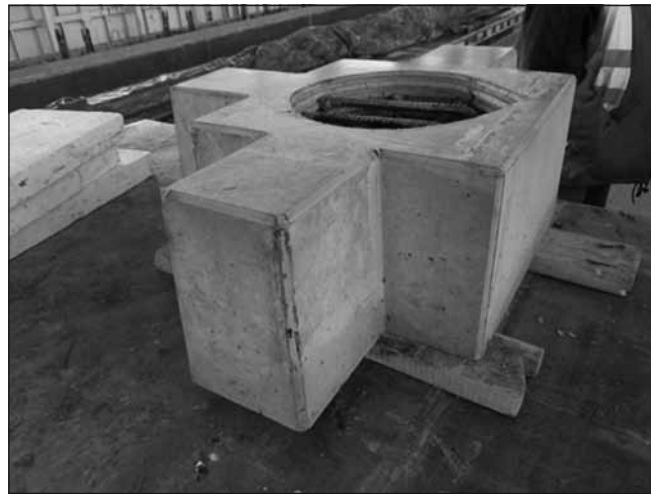
12. ábra: Fekve gyártás, a körzsalu felül 12 cm széles sávban nyitott
