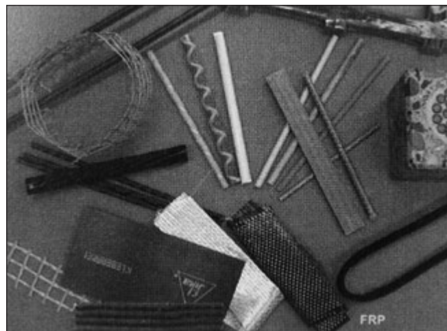
1. ábra: Néhány jellegzetes FRP anyagú építőiparban felhasznált termék (feszített és nem feszített betét, háló, szalag, szövet) (Stijn Matthys: FRP Training Course, Ghent, 2015)
