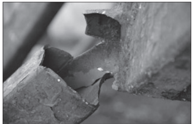
16. ábra: Részben a hegesztési varrat, részben az acél anyagának tönkremenetele (Testnevelési Egyetem tüzesete, 2015. okt. 15.)
