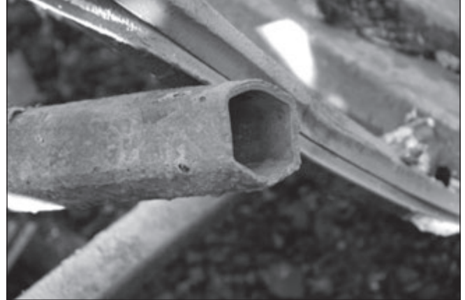
15. ábra: A hegesztési varrat tönkremenetele (Testnevelési Egyetem tüzesete, 2015. okt. 15.)
