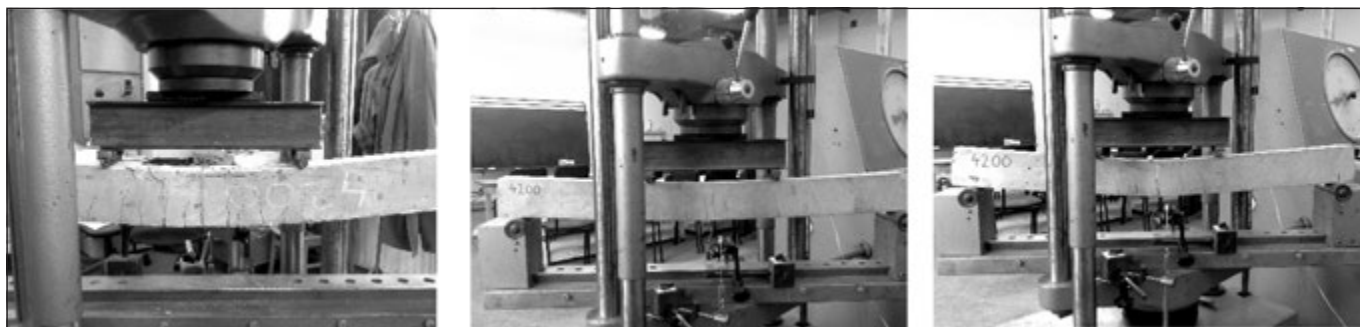
3. kép: Normálvasalású gerendák repedésképe és jellemző tönkremenetele
