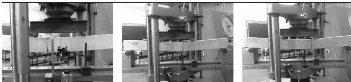
2. kép: Alulvasalt gerendák jellemző repedésképe és tönkremenetele
