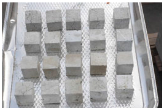
a) a beton változása a hőmérséklet hatására
