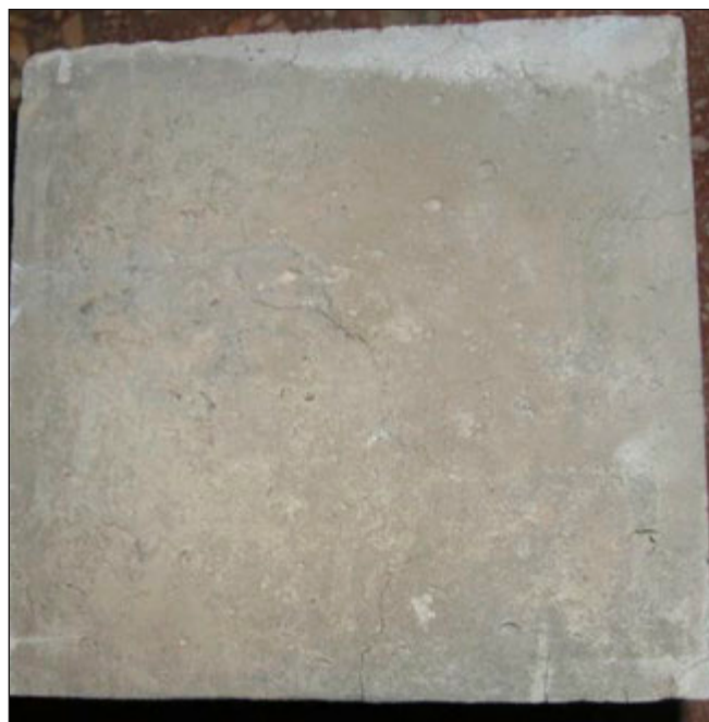
6. ábra: CEM III/A 32,5 N jelű cementtel készült beton repedésképe a 800°C-os hőterhelést követően
