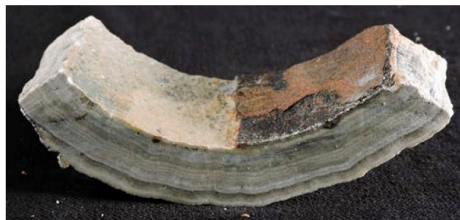
9. ábra: Zsóry-fürdőben eltávolított vízkő kiválás (A fényképet Szakáll Sándor, a Miskolci Egyetem Ásvány- és Kőzettani Intézeti Tanszékének vezetője bocsátotta rendelkezésünkre)
