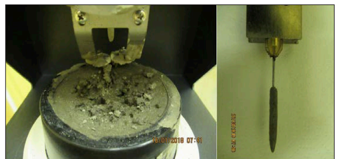
5. ábra: Radioaktív cementpép kötési idő meghatározása (hibás mérés)
