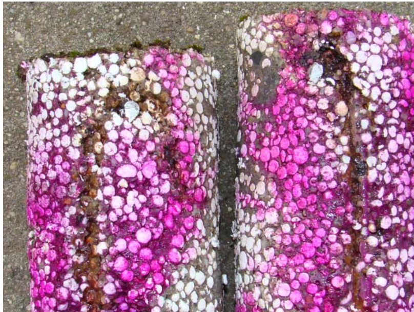
10. fotó: A fűrt minta palástján csak rozsdanyomok maradtak
