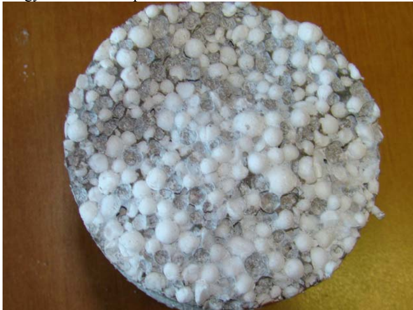
14. fotó: A beton szakadási képe. Legtöbb helyen a gyöngyök szakadtak el
