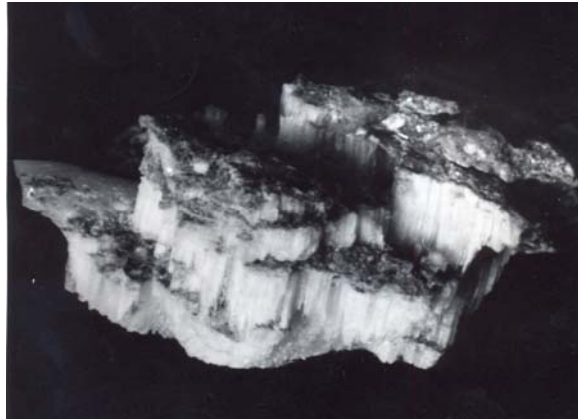
1. ábra: Beton lehámlásos tönkremenetele, amelyet NaCl kristályok képződése idézett elő (fotó: Dr. Erdélyi Attila)
