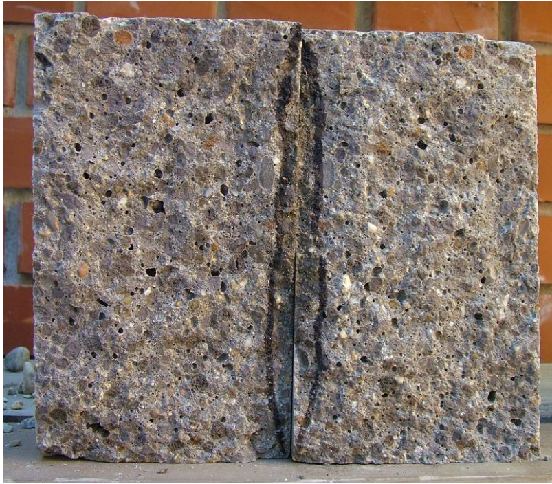
8. ábra : Duzzasztott agyagkavicssal készített próbatesten mért vízbehatolási mélység: 10-12 mm.
