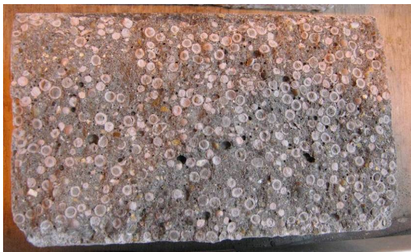
9. ábra : Duzzasztott üveghabkavicssal készített próbatesten mért vízbehatolási mélység 6-7 mm.
