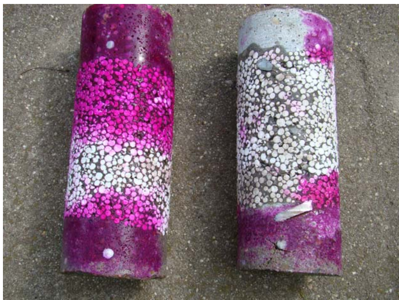
11. fotó: A szendvics szerkezetű panelek keresztmetszeti képe. Nagyon kis mértékben karbonátosodott a beton
