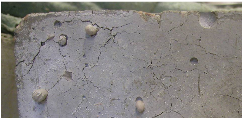
23. ábra: A habüveg1 adalékanyagos beton felületén a 2 órán át tartó, 800°C-os hőterhelést követően a habüveg szemcse kifolyt
