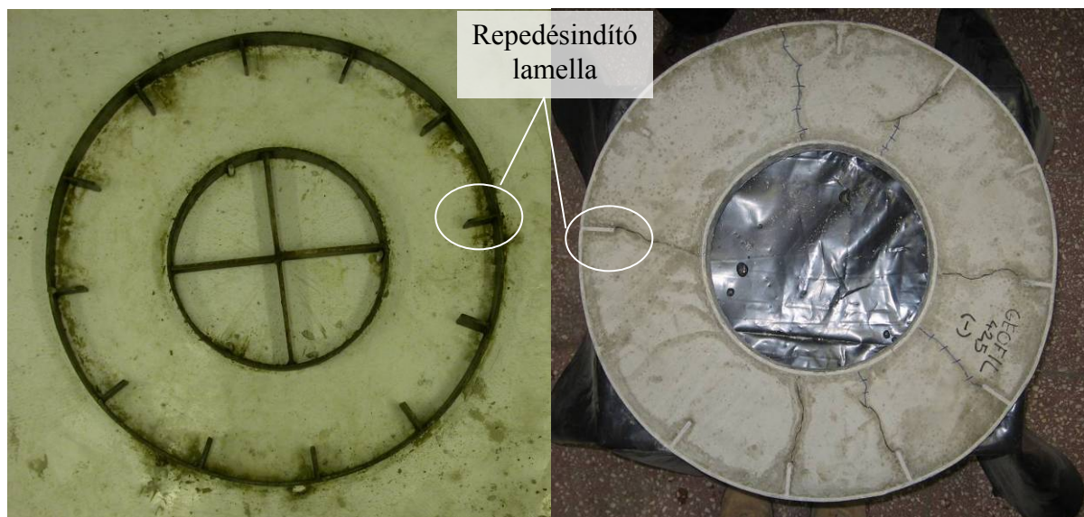
14. ábra: Repedésindító lamellákkal ellátott sablon és próbatest repedésvizsgálathoz
