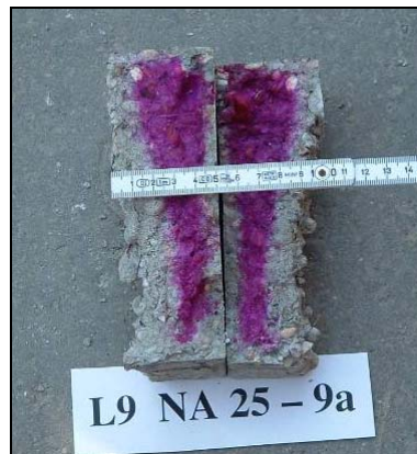
11. ábra: A legerősebben lehámlott, L9 jelű próbatest (megjegyzés: a középső, nem színes nyomtatásban sötétebb tónusú tartomány fenolftalein pozitív, \text{pH} < 9 , a portlandit kioldódott, a felület tönkrement)
