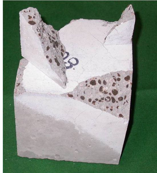
22. ábra: A duzzasztott agyag adalékos könnyűbeton próbatestek sarkainak lerepedése a 800°C hőterhelés hatására
