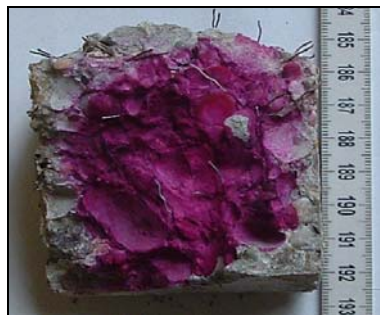
12. ábra: A -módszerrel fagyasztott-olvasztott 75×75×150 mm-es acélszálás (75 kg/m 3 ) betonhasáb törete 10 éves korban hasítva (megjegyzés: a középső, nem színes nyomtatásban sötétebb tónusú tartomány fenolftalein pozitív, \text{pH} < 9 , a portlandit kioldódott, a felület tönkrement)
