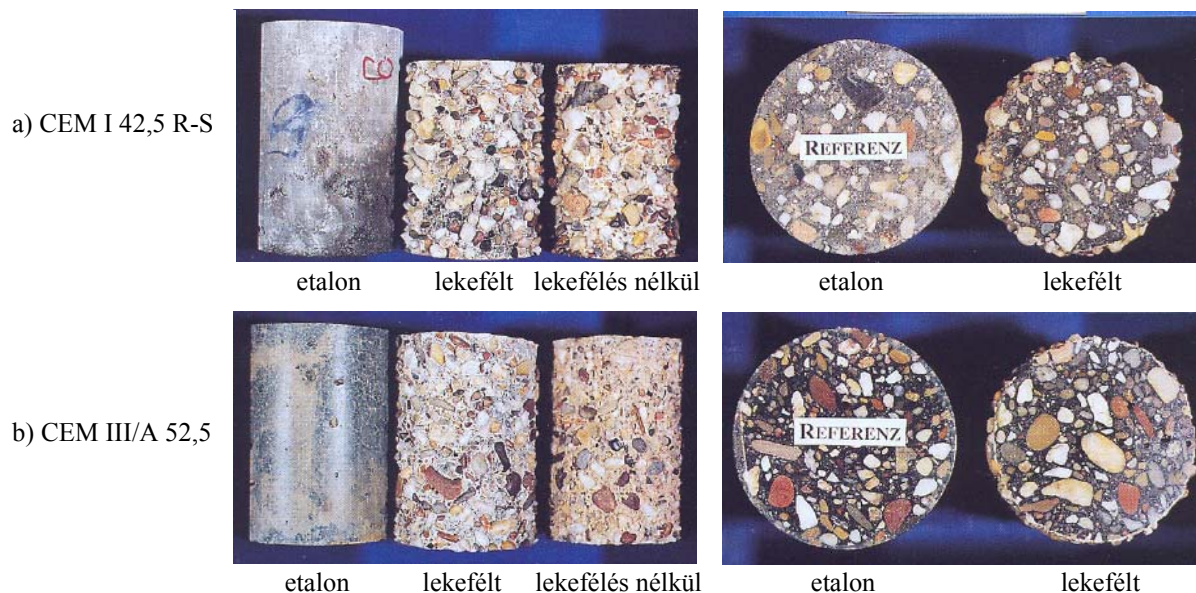
10. ábra: CEM I 42,5 R-S szulfátálló referencia cementtel (a) és CEM III/A 52,5 jelű kohósalak cementtel (b) készült próbatestek állapota 150 napos kénsavterhelés (pH=1) előtt és után (Franke, 1999)
