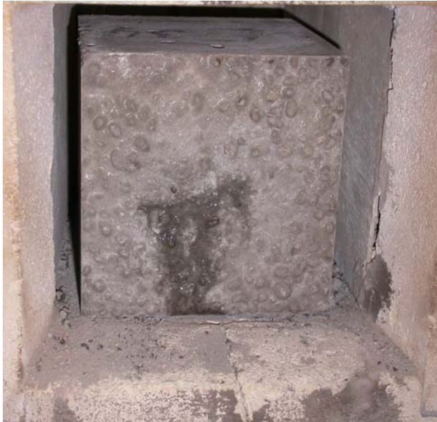
21. ábra: A hőterhelés során a víz távozása a duzzasztott agyag adalékos könnyűbeton próbatestekből.
