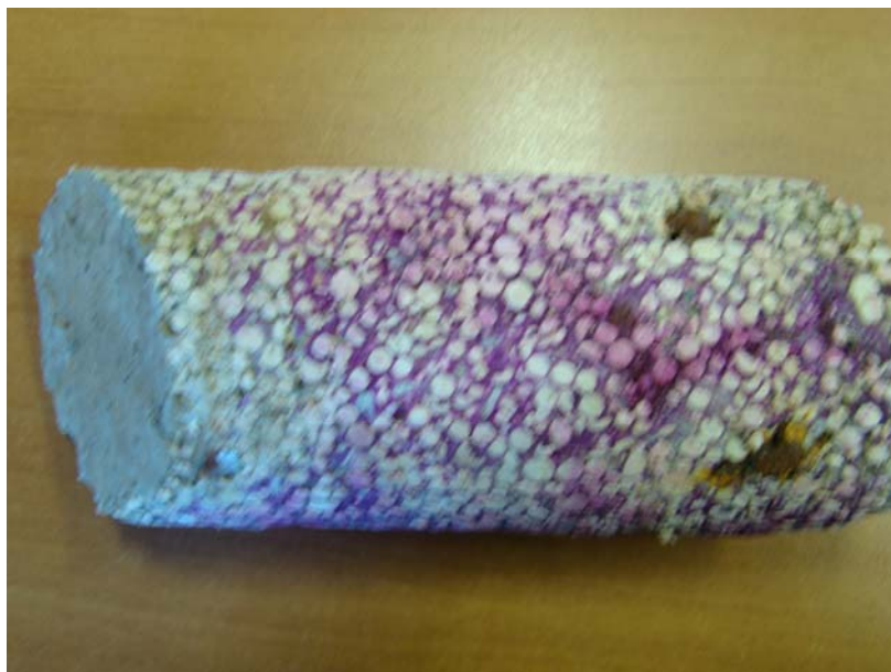
12. fotó : Az acélbetétek a fűrt minták karbonátos helyein rozsdásodnak
