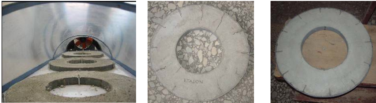
4-6. kép: A szélcsatornában végzett forszírozott szárítás modellezi a meleg, szeles építéshelyszíni körülményeket, segít a repedésmentes összetétel kikísérletezésében
