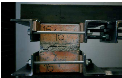
Fig. 13 A hajlításra felszakított próbatest a törőgépből és a szétválasztott habarcságy felülete
