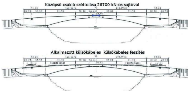
17. ábra. A híd megerősítése
