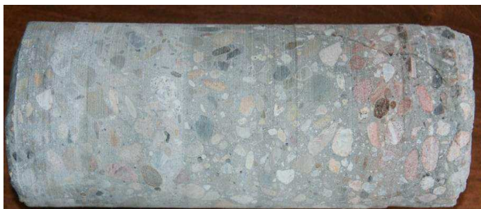
4. ábra: A beton színének változása a tűz hatás során
