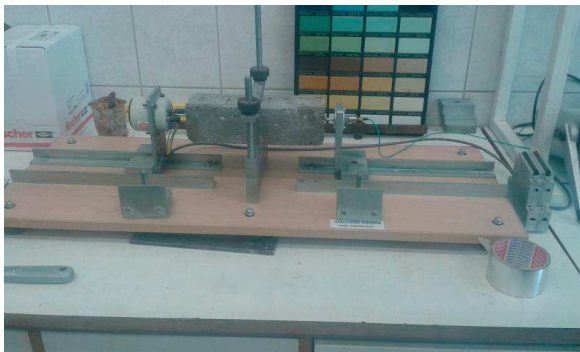
13. ábra 70x70x250 mm-es próbatest önrezgésszámának mérése. ÉMI
