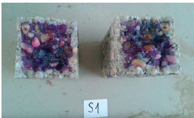
12. ábra Az F&T beton fenolftalein-es vizsgálata
