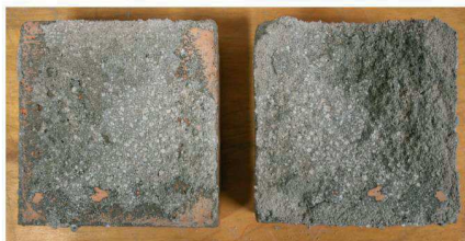
Fig. 13 A hajlításra felszakított próbatest a törőgépből és a szétválasztott habarcságy felülete
