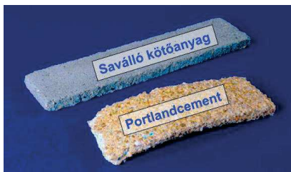
8. ábra Kénsavban áztatott próbatestek roncsolódása 75 napos tárolás után: alul egy tiszta szulfátálló portlandcementből készült, felül pedig cementet, pernyét és mikroszilikát is tartalmazó 10x40x160mm-es habarcschasáb látható. (Hüttl - Hillemeier, 2000)
