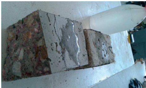
14. ábra Vízben (elől) és ecetsavban (hátral) tárolt beton próbatest nedvesedése
